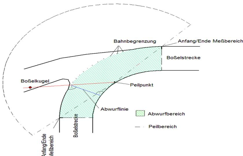
Der nächste Abwurf erfolgt rechtwinklig zur Wurfbahn vom Schnittpunkt Peillinie Außenkurve. ( Skizze ).
